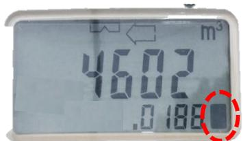
自宅内外の蛇口が完全に閉まっていて、水道が使用されていないことを確認してください。建物の外に設置されている水道メーター隔測表示機を見ます。右下にある四角いマークが点滅していれば、漏水している可能性があります。
